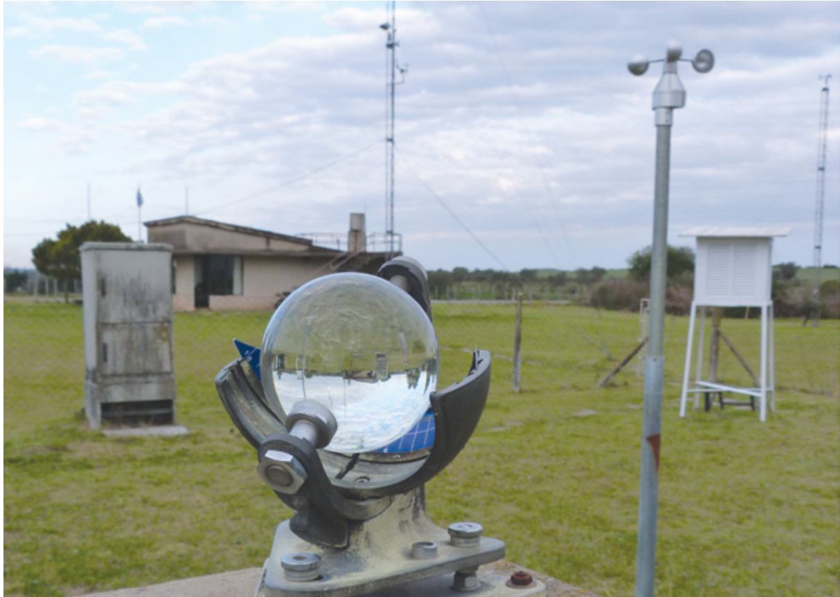
Heliógrafo, parque de una estación meteorológica en Uruguay.
